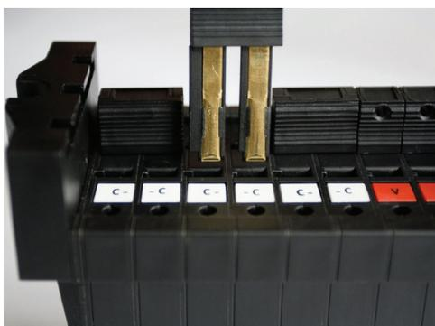
Los pines de desconexión para las señales de corriente garantizan el cortocircuito entre polos adyacentes del bloque de prueba. Este cortocircuito ocurre en el lado A del bloque de prueba (señales de campo), lo que impide la apertura de los circuitos secundarios de los transformadores de corriente (TC).
