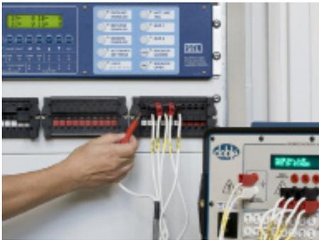
Los bornes banana del lado B son usados para la inyección secundaria. El acceso a estos bornes solamente es posible cuando los pines de desconexión están insertados en el slot inferior (contactos abiertos).
