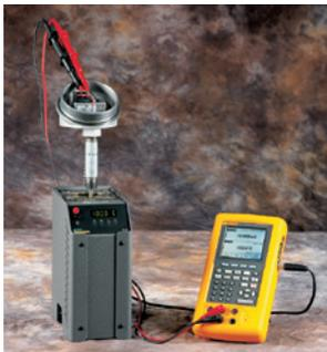
Los hornos secos de calibración de Fluke Calibration se conectan directamente al Fluke 754, con lo que se consigue una calibración totalmente automatizada.
