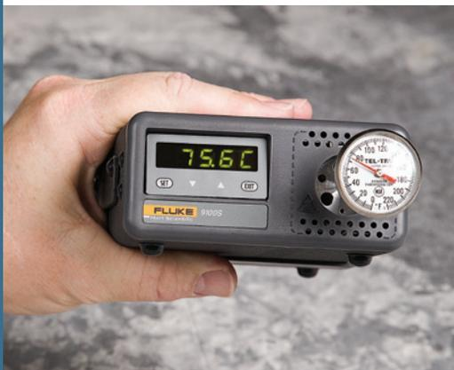
La calibración de los sensores de temperatura es fácil con un horno seco de calibración de mano.
