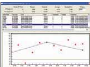
Figura 2: Tendencia rápida de cualquier punto de prueba. Los valores históricos se muestran en azul con líneas de conexión. Los valores para equipos similares se muestran en rojo. Una tabla arriba del gráfico de tendencia lista todos los valores de datos, junto con los datos de prueba y ubicación del equipo.
