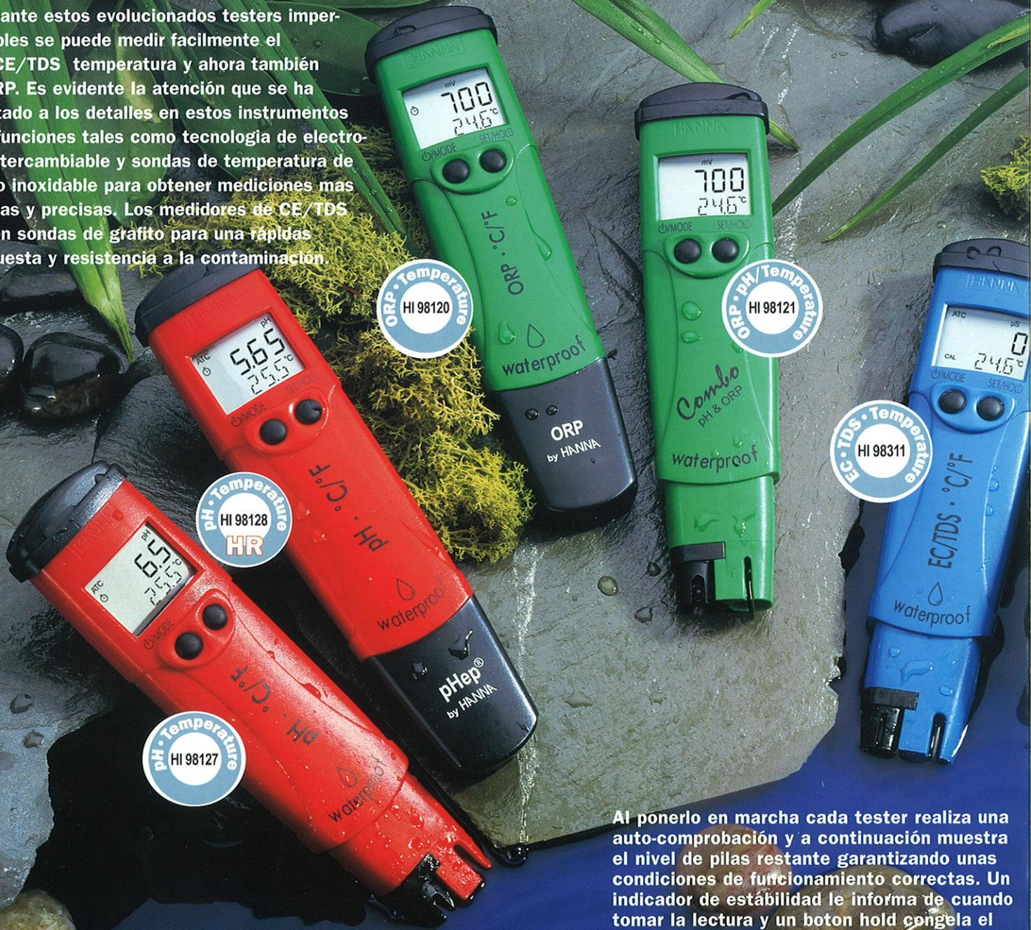
Al ponerlo en marcha cada tester realiza una auto-comprobación y a continuación muestra el nivel de pilas restante garantizando unas condiciones de funcionamiento correctas. Un indicador de estabilidad le informa de cuando tomar la lectura y un boton hold congela el display para una toma de datos mas fácil y precisa. Toda la información se muestra en un display que presenta toda la información de una sola vez.
