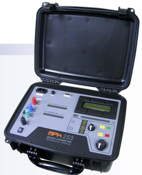
El micro-ohmímetro digital **MPK-253** es un instrumento realmente portátil, controlado por microprocesador, destinado a medir con alta precisión resistencias muy bajas de contacto de disyuntores y llaves, barras conductoras, bobinados de transformadores y motores, etc., con corrientes de prueba desde **1mA** hasta **10A**.
