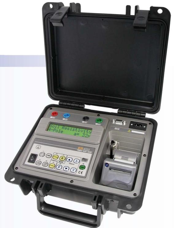
El telurómetro **EM-4055** es un instrumento digital, controlado por microprocesador, que permite medir resistencias de tierra y resistividad del suelo por el método de Wenner, así como detectar las tensiones parásitas presentes en el terreno. Es el equipo adecuado para la medición de sistemas de tierra de subestaciones, redes de distribución de energía, instalaciones domésticas e industriales, pararrayos, etc.
